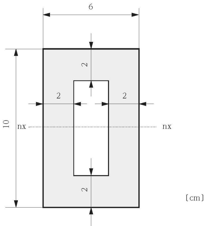
[問 8] 次の図のような寸法の容器内に水を入れて満たしたとき、容器内の水に働く重力の大きさは **28** **29**.**30** [kN] である。ただし、水の密度は  $1000\text{kg/m}^3$ 、重力の加速度は  $9.8\text{m/s}^2$  とする。
